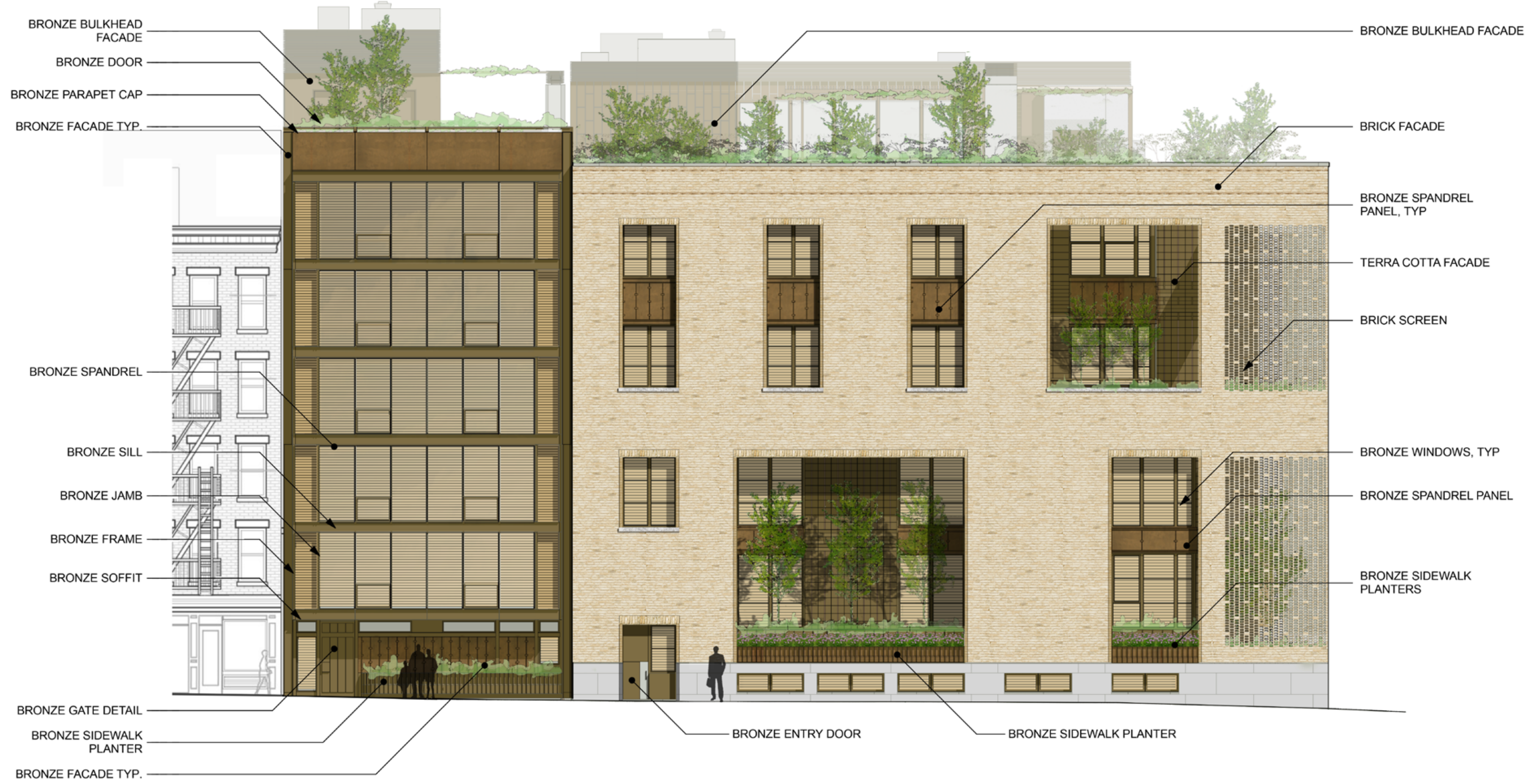
WEST ELEVATION (WASHINGTON STREET) SCALE: 1/8" = 1'-0"
